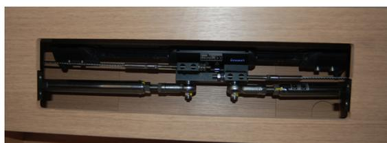
La trasmissione della timoneria è una delle componenti che più ci ha colpito. Questa è della Lewmar ed è tra le più avanzate trasmissioni presenti sul mercato. Non ci sono catene, il movimento è trasmesso dalla ruota al timone a bracci idraulici attraverso dei frenelli di acciaio.
