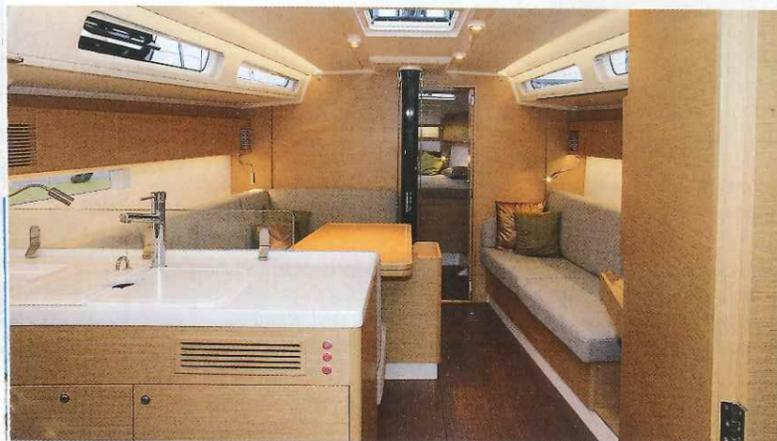
Longueur coque : 12,50 m. Longueur flottaison : 11,31 m. Largeur : 3,95 m. Tirant d'eau : 2,20 m. Déplacement : 8,85 t. Lest : 3,8 t. Surface de voile au près : 97 m<sup>2</sup>. Génois : 43 m<sup>2</sup>. GV : 54 m<sup>2</sup>. Matériau : verre/mousse. Architecte : Niels Jeppesen. Constructeur : X-Yachts. Prix : 341000 €.
