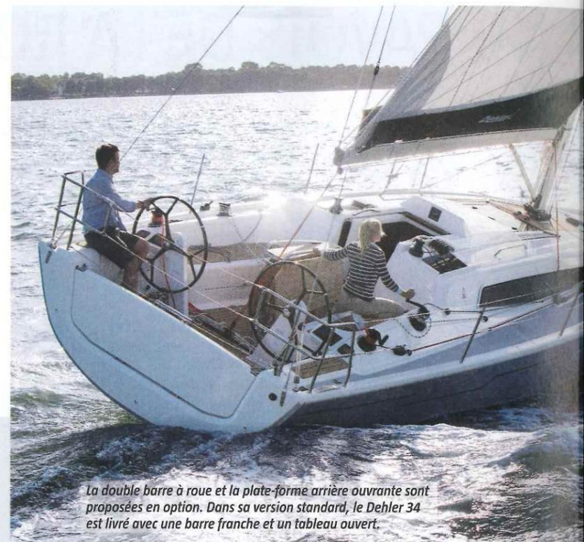
La double barre à roue et la plate-forme arrière ouvrante sont proposées en option. Dans sa version standard, le Dehler 34 est livré avec une barre franche et un tableau ouvert.
