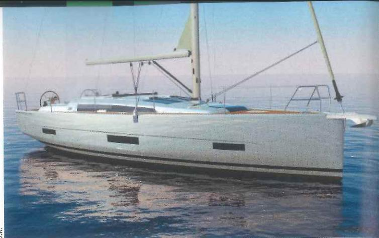
**390 GL** ▲ Longueur: 11,19 m. Largeur: 3,90 m. Tirant d'eau: 1,90 m. Déplacement: 7 490 kg. Lest: nc. Surface de voile au près: 71 m<sup>2</sup>. Génois: 31 m<sup>2</sup>. Grand-voile: 40 m<sup>2</sup>. Matériau: strat. verre polyester. Architecte: Umberto Felci. Constructeur: Dufour. Prix: nc.
