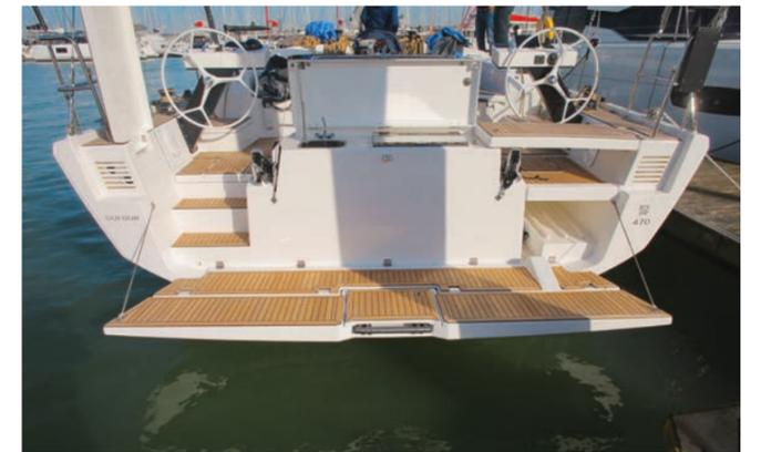
**Plate-forme.** Le tableau basculant donne accès à la survie (sur tribord) mais aussi à une cuisine extérieure avec plancha et évier. Cette plage de bain est ici motorisée.
