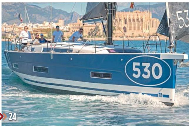
**24.** A pesar de su eslora y desplazamiento, el Dufour 530 en su versión Performance es un barco que arranca bien con vientos flojos y mantiene una gran inercia con buenas velocidades. Muy maniobrable y con gran respuesta al buen trimado.
