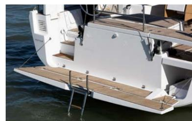
Des critiques sont possibles tout au plus à la poupe. Le grand rangement central sur le pont arrière est plutôt dérangeant pour les manœuvres – même si, recouvert de capitonnages, il peut être utilisé comme solarium. La plateforme de bain rabattable ne semble en outre pas complètement au point. Ouverte, elle présente de grandes fentes et, fermée, elle clapote en cas de houle...
