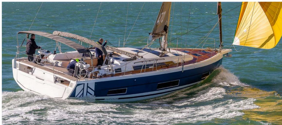
La coque se voit doter d'une rigidité supplémentaire grâce à deux bouchains – l'un presque en continu au-dessus de la ligne de flottaison pour une meilleure stabilité de forme en cas de gîte, et l'autre sous la forme d'un renforcement pour les grands et longs hublots de coque. Ces derniers ont ainsi pu être montés en retrait, leur permettant d'être mieux protégés contre les dommages causés par les défenses ou lors de l'entrée dans une place d'amarrage.
